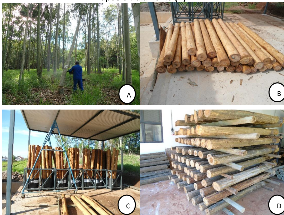
Figura 3 - Local de retirada das árvores (A), toretes já descascados (B), toretes durante o tratamento (C), toretes armazenados no pátio de secagem ao ar livre, após o tratamento (D).
