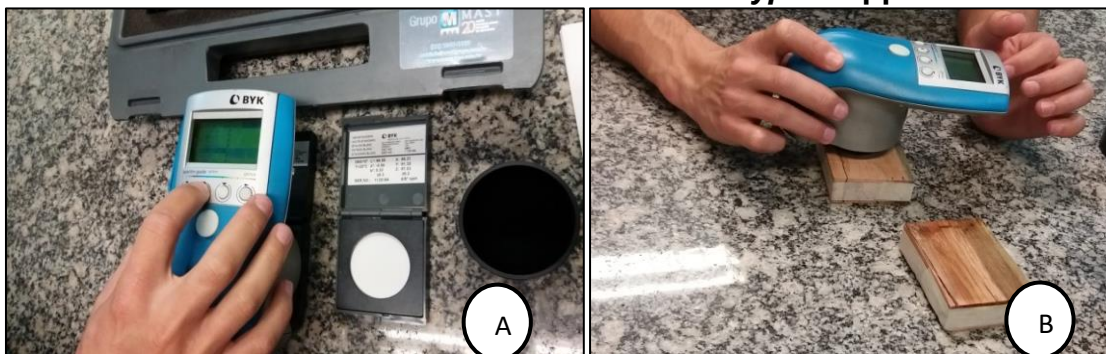
Figura 8 - Calibração do espectrofotômetro e determinação dos parâmetros colorimétricos da madeira de Eucalyptus spp.
