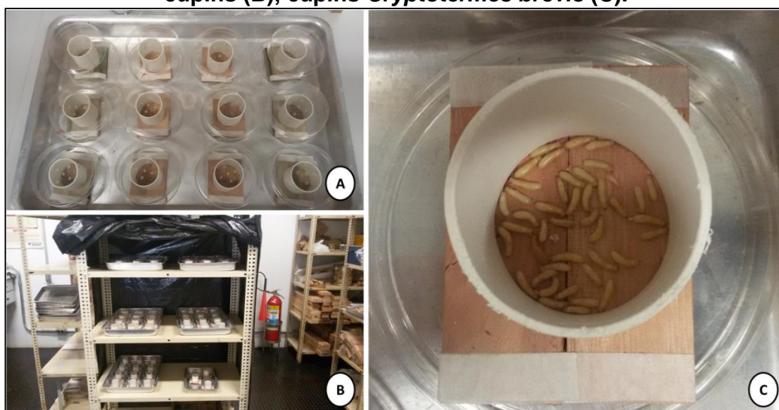
Figura 6 - Mangas de PVC (A), câmara climática e os corpos de prova com cupins (B), cupins Cryptotermes brevis (C).
