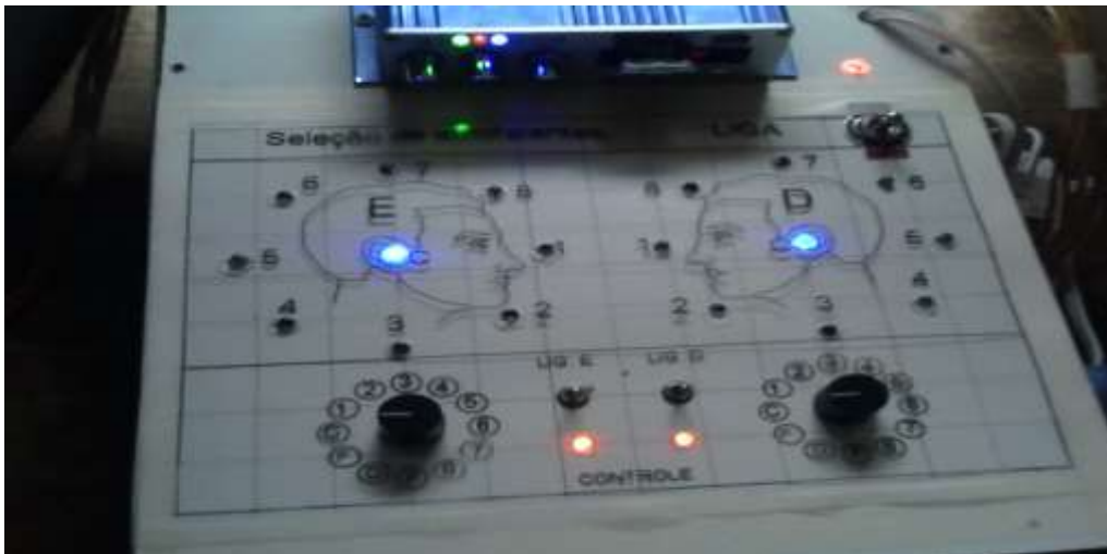
Figura 51 – Foto cx. controle ligada, com a seleção dos dois canais e autofalantes centrais, C.
