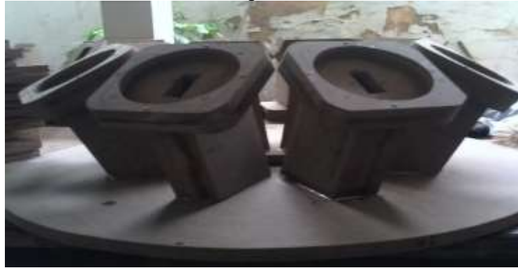
Figura 30 – Foto das cornetas fixadas ao tampo das caixas, vista lateral.
