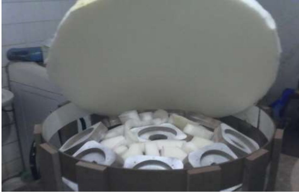
Figura 36 – Foto detalhe da colocação da isolamento acústica interna e fundo.
