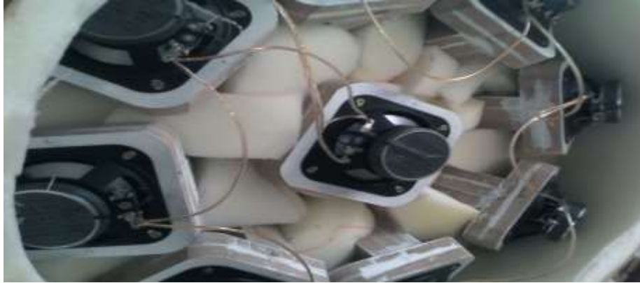
Figura 40 – Foto interna, com ligação parcial dos autofalantes.
