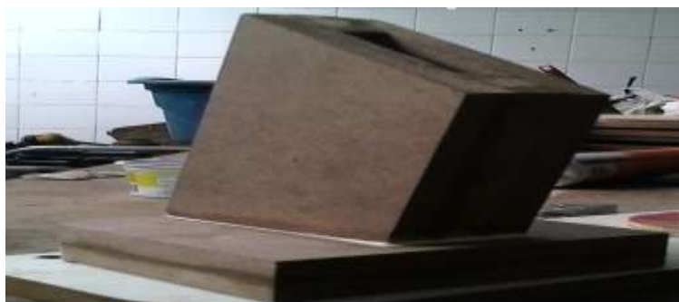
Figura 29 - Foto da corneta fixada às bases do autofalante.
