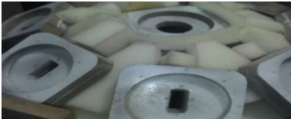
Figura 34 – Foto detalhe da colocação da isolamento acústica interna, entre as cornetas.
