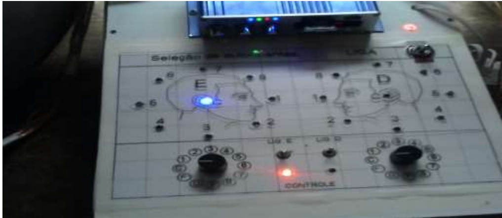
Figura 50 – Foto da cx. controle ligada, c/ seleção do canal esquerdo, autofalante central C.
