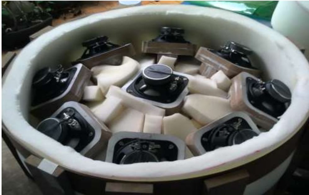
Figura 38 – Foto detalhe dos autofalantes com da isolamento acústica interna.
