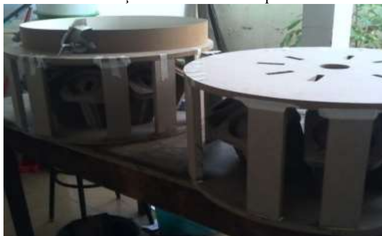
Figura 32 – Foto detalhe da colocação das bordas do tampo. I.
