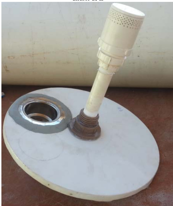
Figura 15 - Fundo do reator aeróbio granular em tubos concêntricos com circulação operado em batelada e difusor de ar
