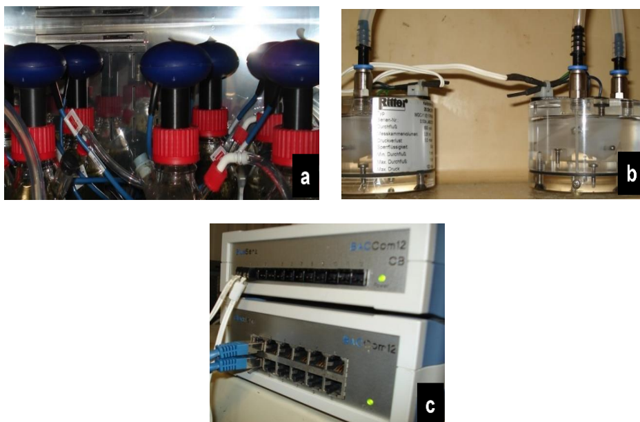
FIGURA 10. Fotografias de alguns elementos da instalação experimental utilizada: (a) sensores óticos BCP-CH4; (b) MilliGascounter® MGC-1; (c) caixa de conexão BACCom 12 (AMORIN, 2015).
