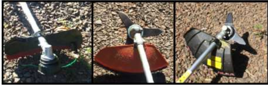
Figura 3.2 – Detalhe do nylon e das lâminas utilizadas nos testes.
