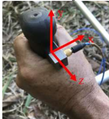
Figura 3.6 – Detalhe da montagem do acelerômetro.
