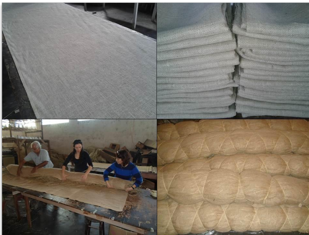
Figura 30 – Processo de confecção do modelo estrutural guirlanda.
