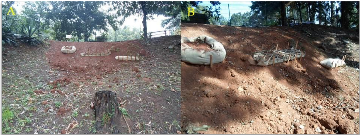
Figura 26 – Teste experimental em talude construído com os protótipos dos modelos.
