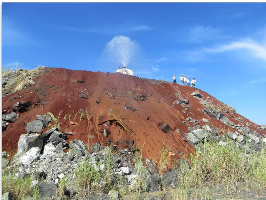
Figura 24 – Simulação da precipitação no talude experimental.
