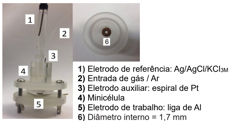
Figura 4. Minicélula eletroquímica e seus componentes, e no detalhe o fundo da célula com o anel de vedação.
