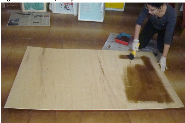
Figura 4.22 — Aplicação da emulsão na madeira
