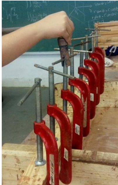
Figura 22 – Aplicação de pressão através de torquímetro e sargentos.
