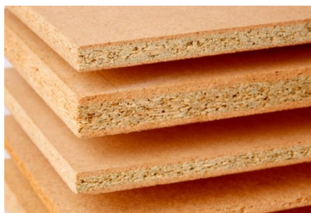
Figura 4 - Painel MDP com destaque para a composição em camadas.
