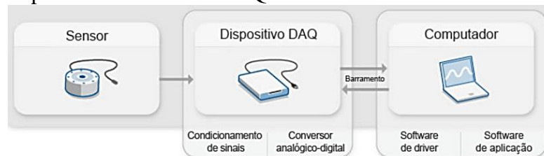
Figura 31 - Os componentes do sistema DAQ.
