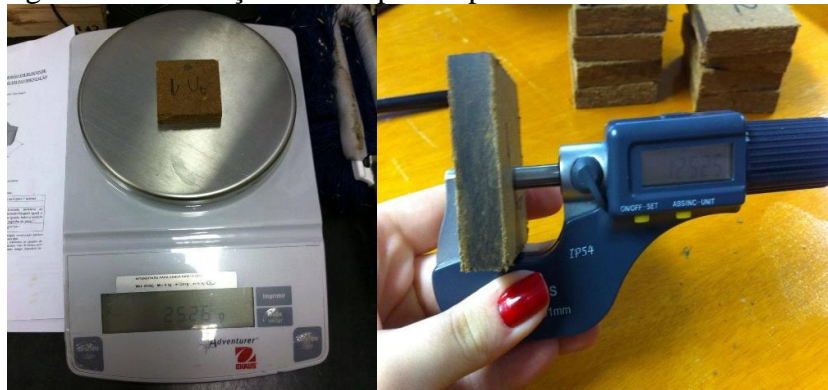
Figura 29 - Pesagem e identificação dos corpos de prova.
