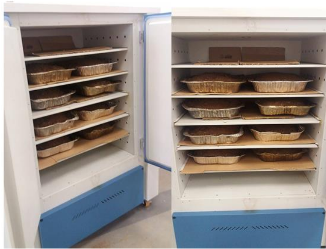
Figura 19 - Secagem das fibras em estufa.
