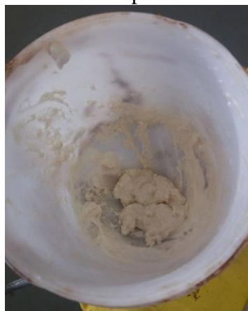
Figura 18 - Formação de grumos da mistura da parafina com o adesivo.
