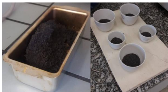
Figura 16 – Sequência de preparação do material: (a) Material após o processo de queima inicial. (b) Acondicionamento em cadinhos.
