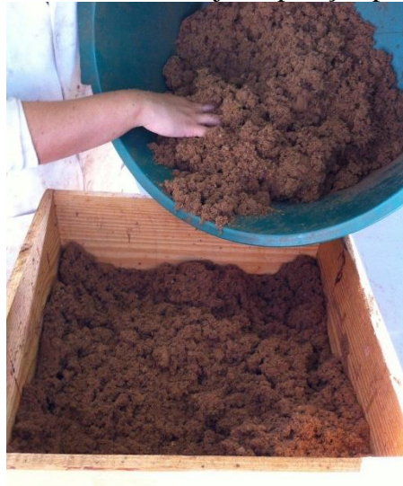
Figura 22 - Caixa formadora com lote de fibras já na posição para a pré-prensagem.
