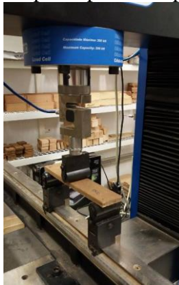
Figura 30- Ensaio de flexão estática: corpo de prova acoplado no equipamento.
