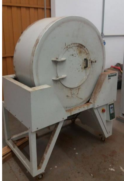
Figura 21 – Encoladeira para a aplicação de adesivo em laboratório.
