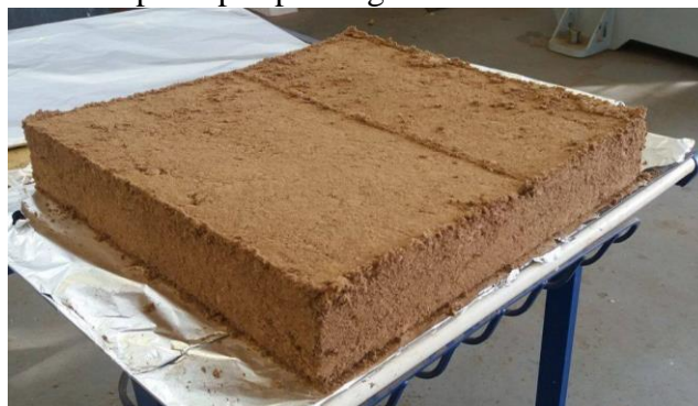
Figura 24 – Colchão de fibras após a pré-prensagem.
