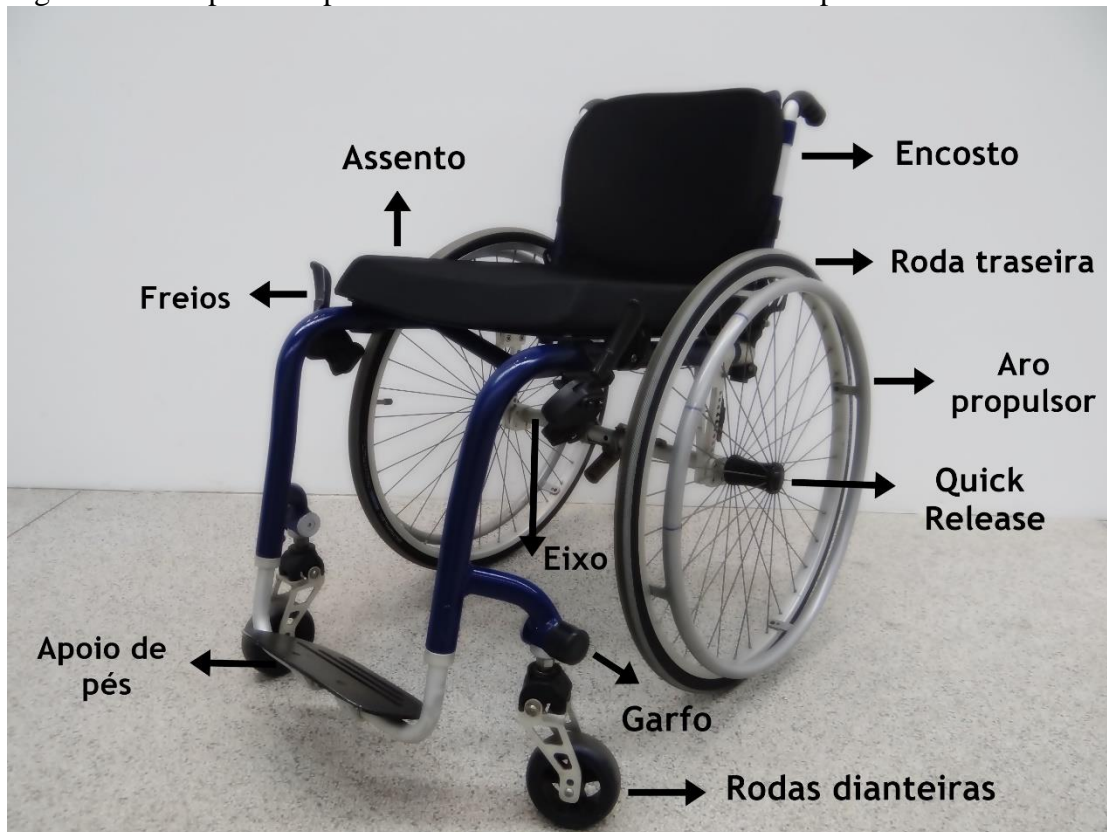
Figura 2: Principais componentes de uma cadeira de rodas do tipo Monobloco.
