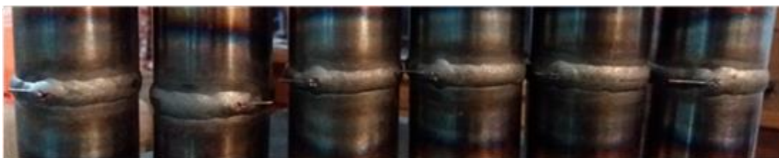
Figura 33: Pares de Juntas soldadas de 30°, 45° e 60° graus, agrupadas da esquerda para a direita, (COELHO, F. e GONÇALVES, G. M. B., 2018).
