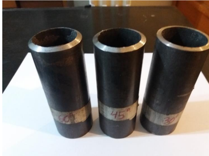
Figura 18: Tubos cortados com plasma e usinados com ângulos Chanfros em 30°, 45° e 60° graus, (COELHO F., GONÇALVES G.M.B., 2018).
