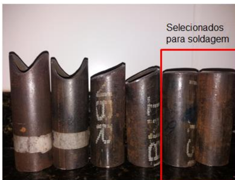
Figura 31: Tubos AISI 4130 cortados no processo plasma com ar comprimido no método de arco não transferido (COELHO, F. e GONÇALVES, G. M. B., 2018).
