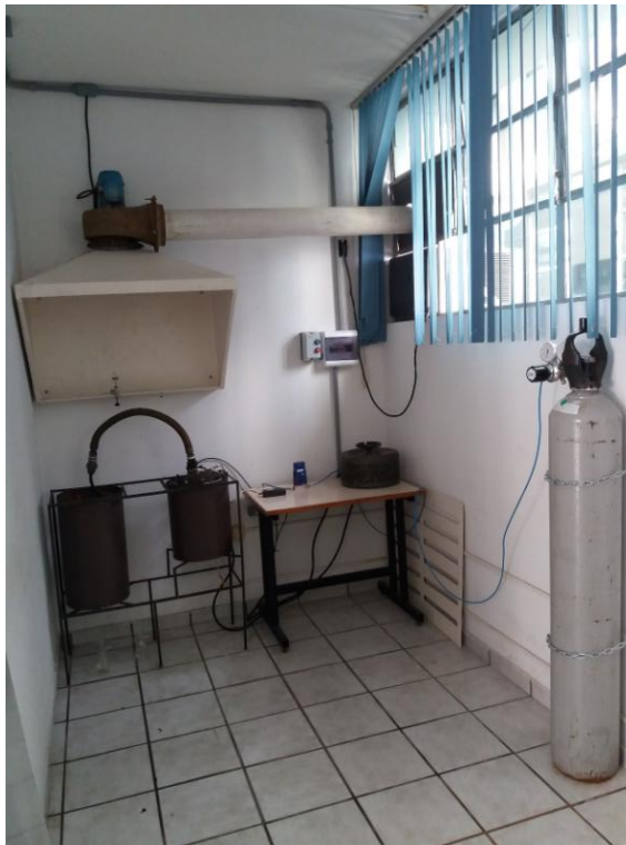
Figura 15 – Bancada experimental construída para o desenvolvimento dos ensaios e pirólise lenta.
