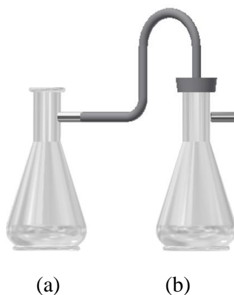
Figura 14 - Reservatório de bio-óleo condensado (a), Lavador de gases (b).
