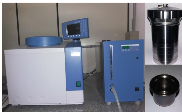
Figura 4 - Bomba calorimétrica composto de um sistema de refrigeração da água; vaso pressurizado e cadinho de inox disponível no LC 3 .
