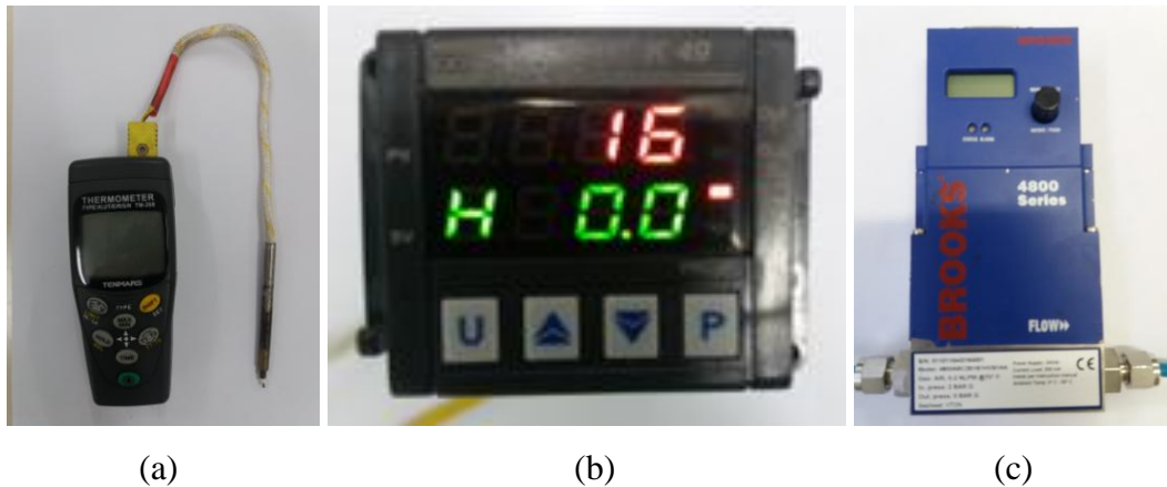
Figura 17 - Termopar tipo K (a), Controlador programável (b), Controlador de vazão (c).
