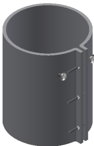
Figura 10 - Resistência elétrica – Vista em perspectiva.
