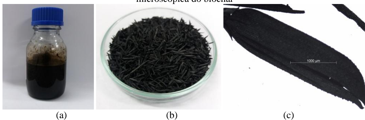
Figura 20 - Produtos da pirólise lenta da casca de arroz: (a) bio-óleo e (b) biochar (c) vista microscópica do biochar
