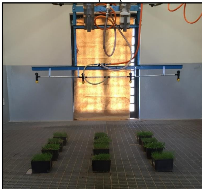
Figura 2 - Pulverizador estacionário com as unidades experimentais no momento da aplicação.
