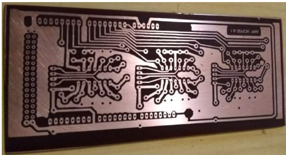
Figura 19 – Shield criado com o circuito impresso em uma placa de fenolite, que recebe os sinais registrados pelos dos sensores flexíveis e os amplificam.
