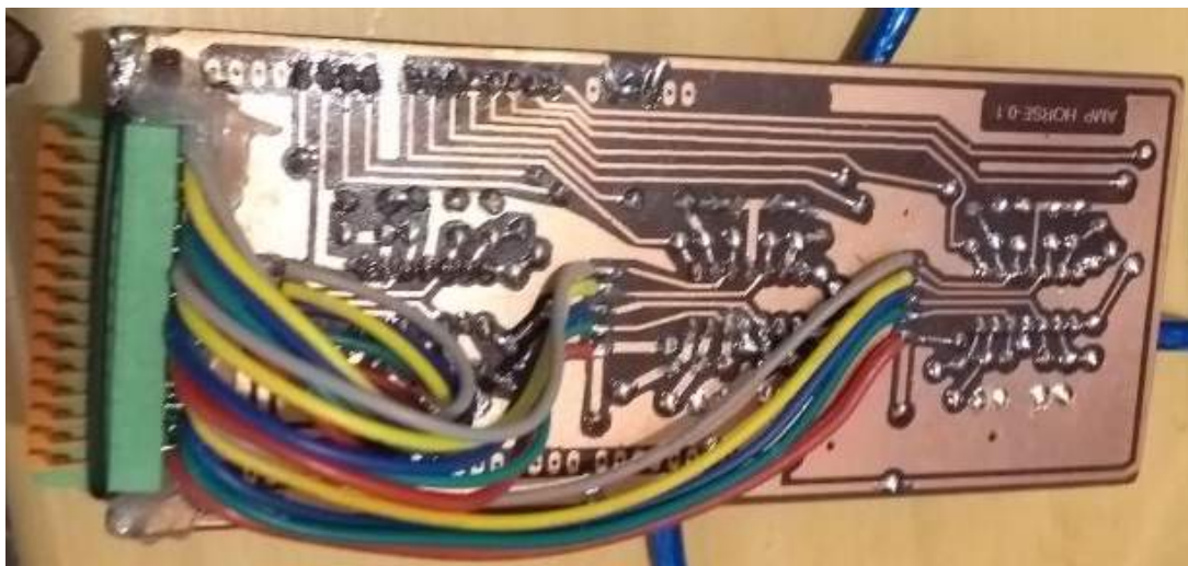
Figura 15 – Shield criado para o Arduino Mega, no qual é ligado os sensores flexíveis. Ele obtém os sinais dos sensores, os amplifica e encaminha para o computador.
