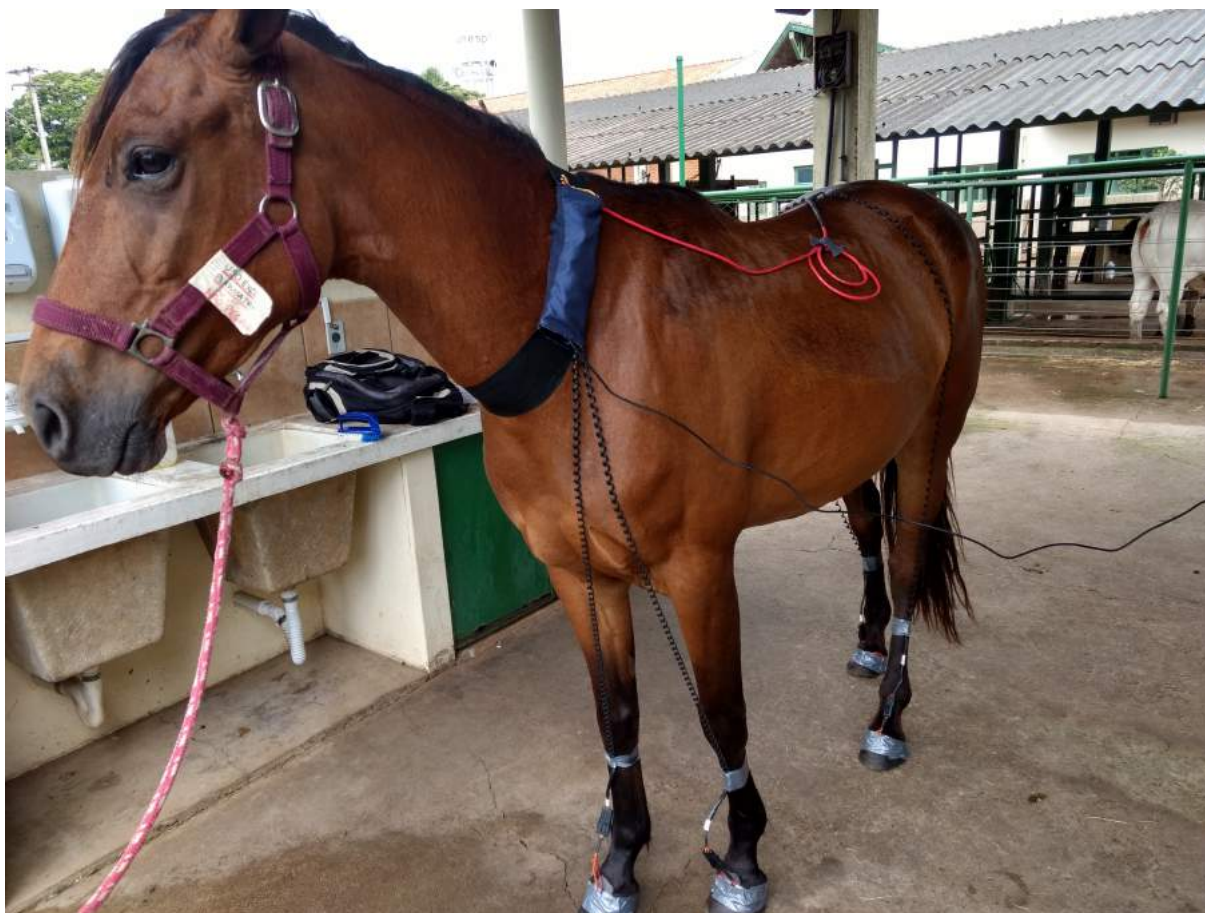
Figura 26 – O dispositivo acomodado no animal na bolsa em azul de onde são ligados os sensores através de cabos espirais.
