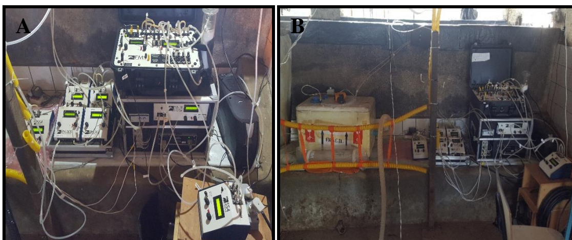
Figura 23 - A) Analisadores de gás (CH 4 , CO 2 e O 2 ) e pressão de vapor (atmosfera, ar expirado e cápsula ventilada); B) Visão geral do sistema de medição fisiológica (SMF).
