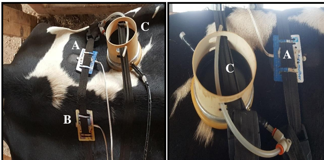
Figura 22 - A) Sensor de temperatura da epiderme; B) Sensor da temperatura da superficial; C) Cápsula ventilada.
