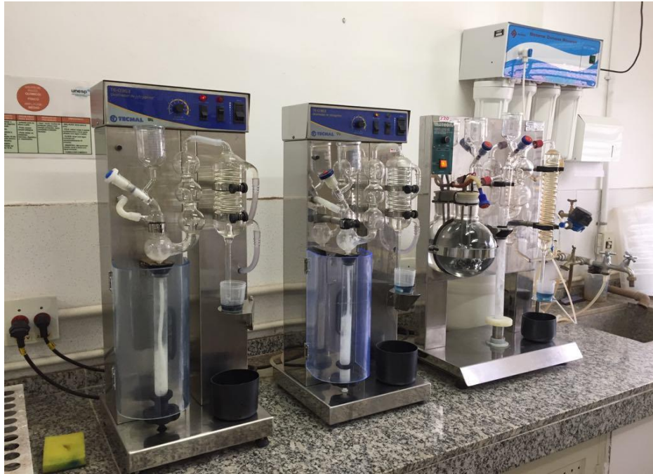
Figura 3 - Determinação do nitrato e do amônio pelo método de destilação a vapor método de Kjeldahl.
