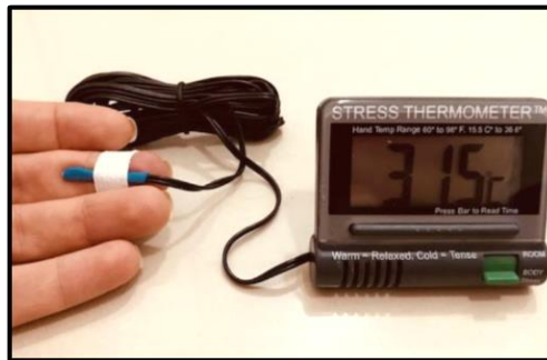
Figura 2 - Stress Thermometer TM (dispositivo com um sensor térmico para medir a temperatura da pele)
