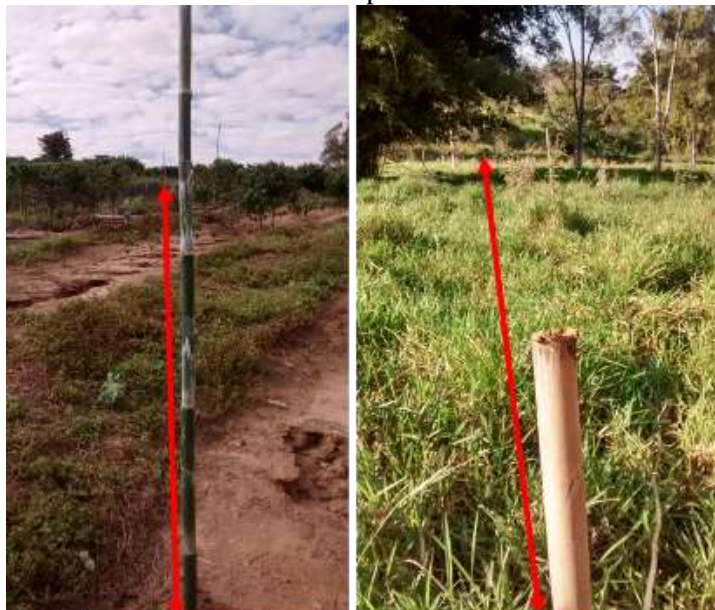
Figura 40: Coleta de dados de comprimento da vertente e declividade
