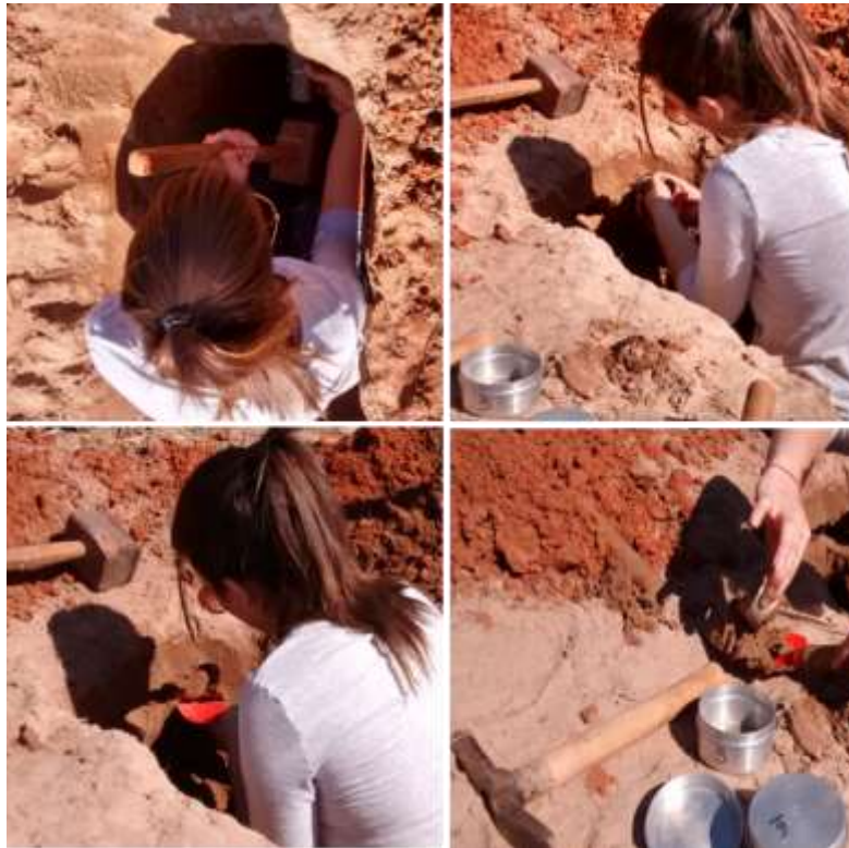
Figura 33: Procedimento de coleta com os anéis volumétricos para obtenção da densidade dos horizontes do solo
