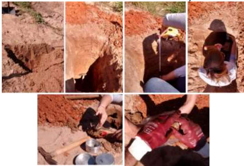
Figura 31: Procedimento de abertura de trincheira e identificação de horizontes e coleta
