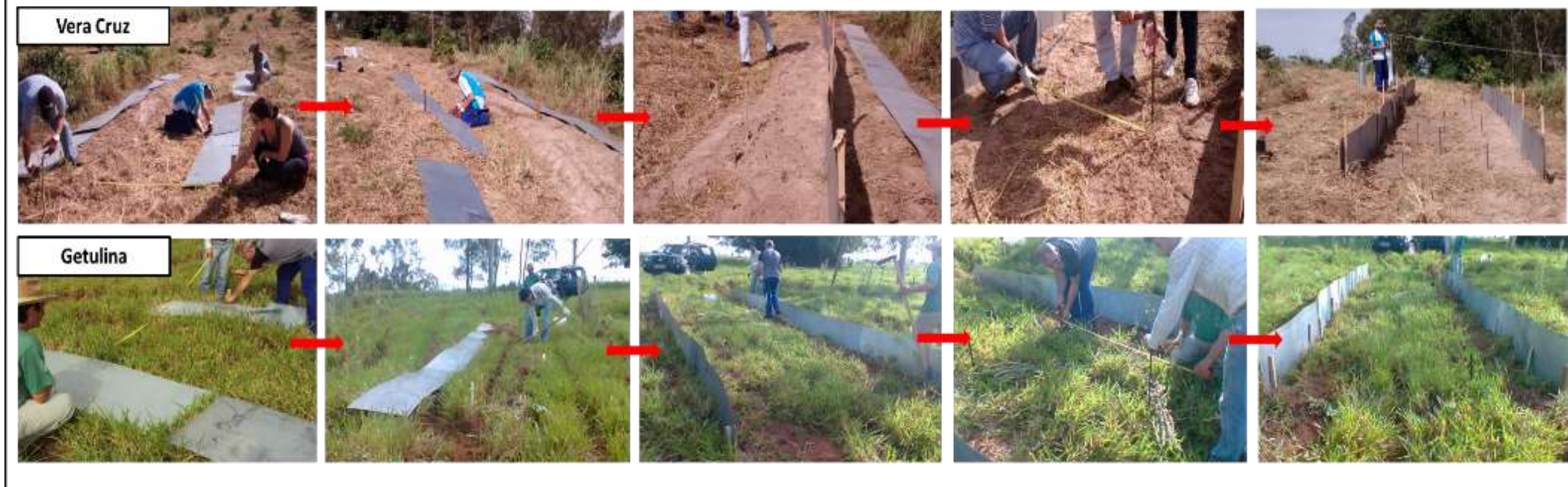
Figura 17: Montagem das parcelas de monitoramento para determinação de perda de solos
