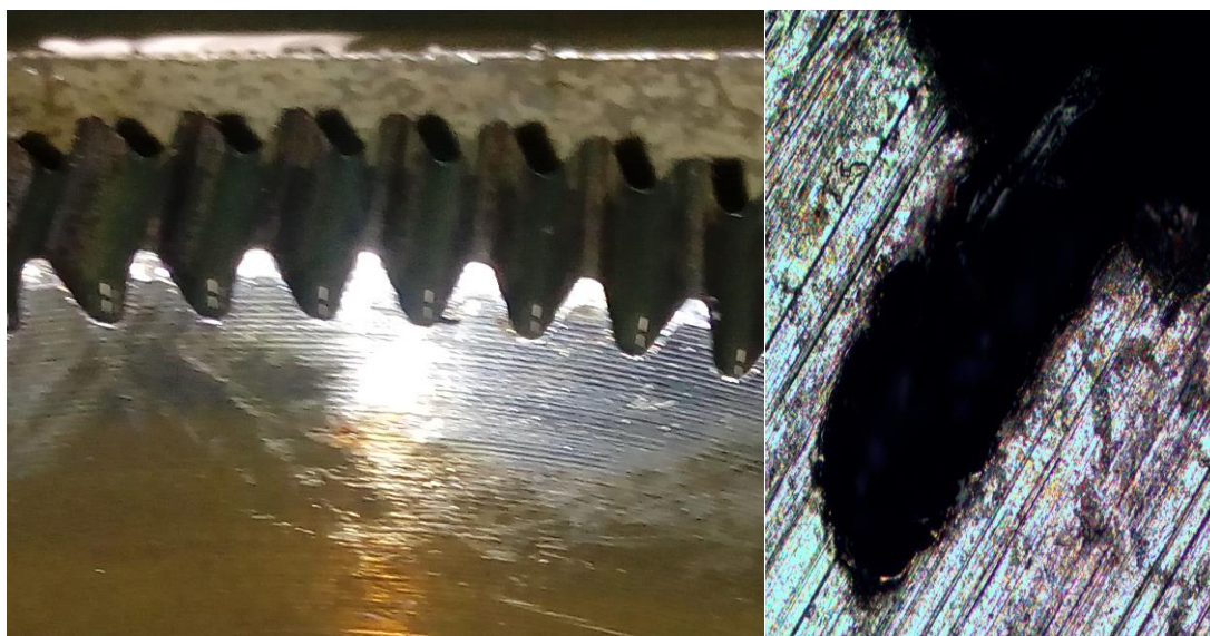
Figura 104 - Acompanhamento do entalhe após 360 horas. a) entalhe na raiz do dente; b) aumento microscópico em 10x.
