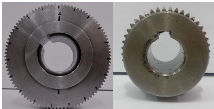
Figura 90 - Coroa e pinhão após o Ensaio 1.
