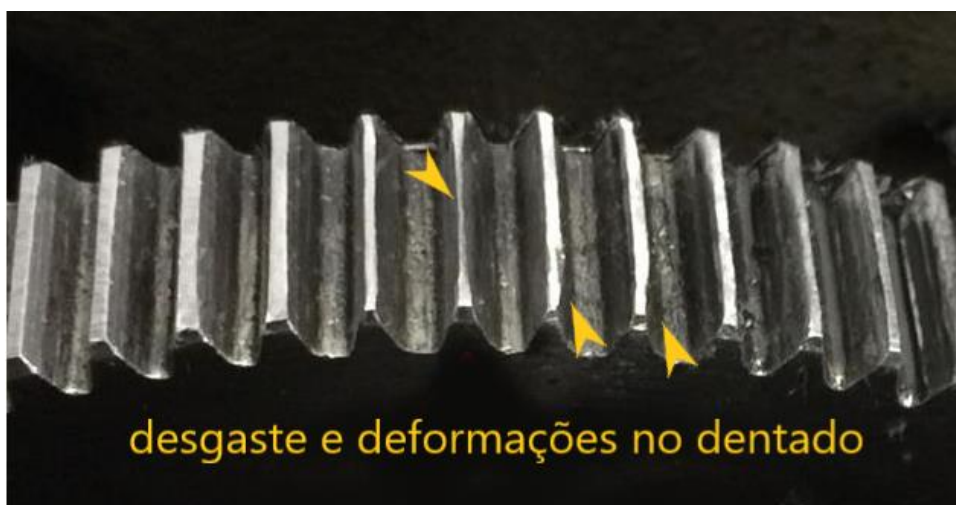
Figura 85 - Desgaste e deformações nos dentes da região 35-40 da coroa após o Ensaio 1.
