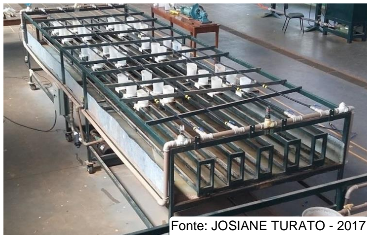
Figura 1 - Bancada de ensaios para tubo gotejadores no Laboratório de Irrigação FCA/Unesp-Botucatu.
