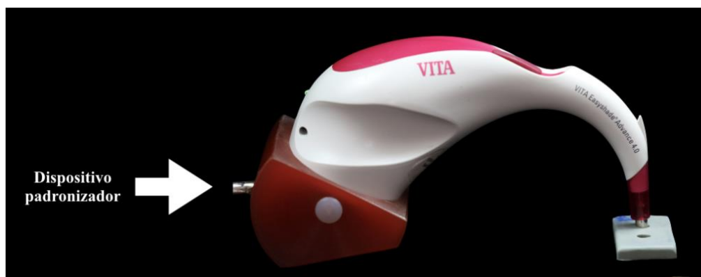
Figura 3 - Espectrofotômetro VITA EasyShade Advance 4.0 posicionado no dispositivo para padronização da mensuração da alteração cromática.
