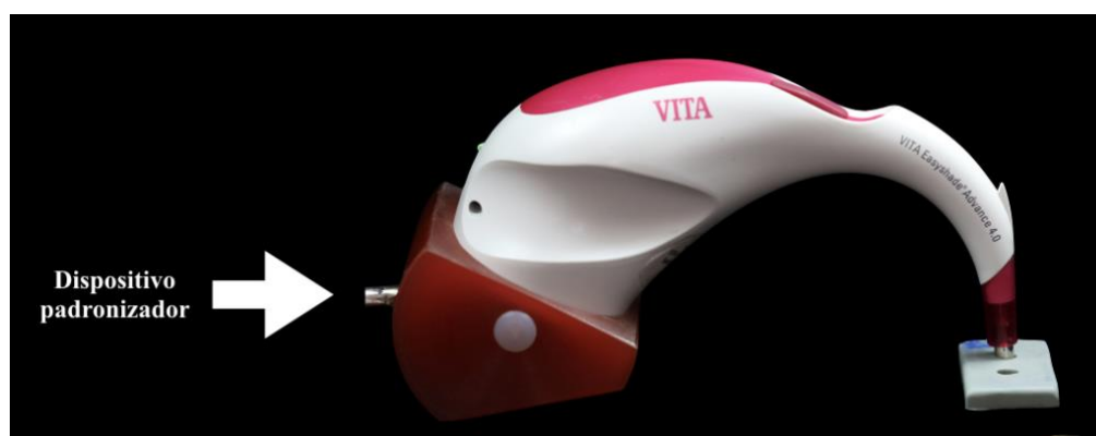
Figura 3 - Espectrofotômetro VITA EasyShade Advance 4.0 posicionado no dispositivo para padronização da mensuração da alteração cromática.
