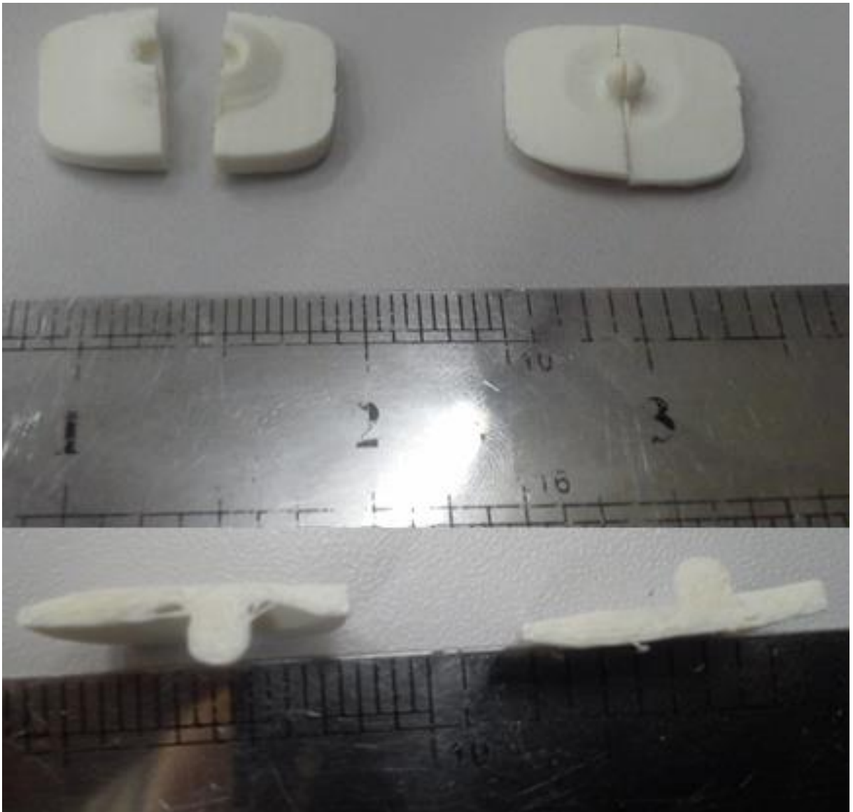
Figura 69 – Superfície esférica da PDI L3/L4 fabricada pelo método FDM com 0,1mm de espessura de camada.
