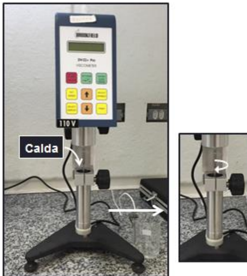
Figura 3 - Viscosímetro rotacional Brookfield, modelo LVDV-II+. No detalhe o spindle utilizado e o sentido de rotação.
