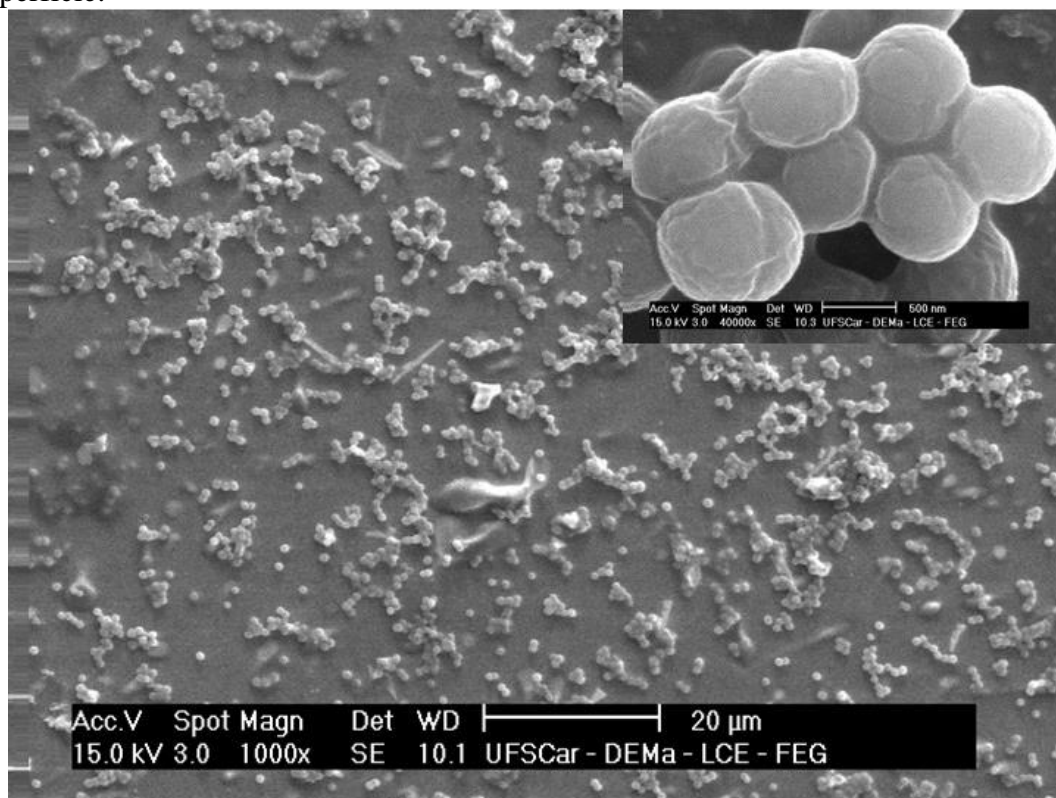
Figura 44 - Superfície da amostra com nanotubos e recobertos com o biopolímero e partículas de ZnO (solução de 3 mM), com microrganismos crescido sobre sua superfície.
