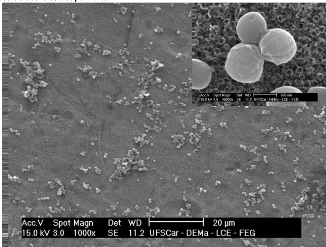
Figura 42 - Superfície da amostra com superfície de nanotubos, com microrganismos crescido sobre sua superfície.
