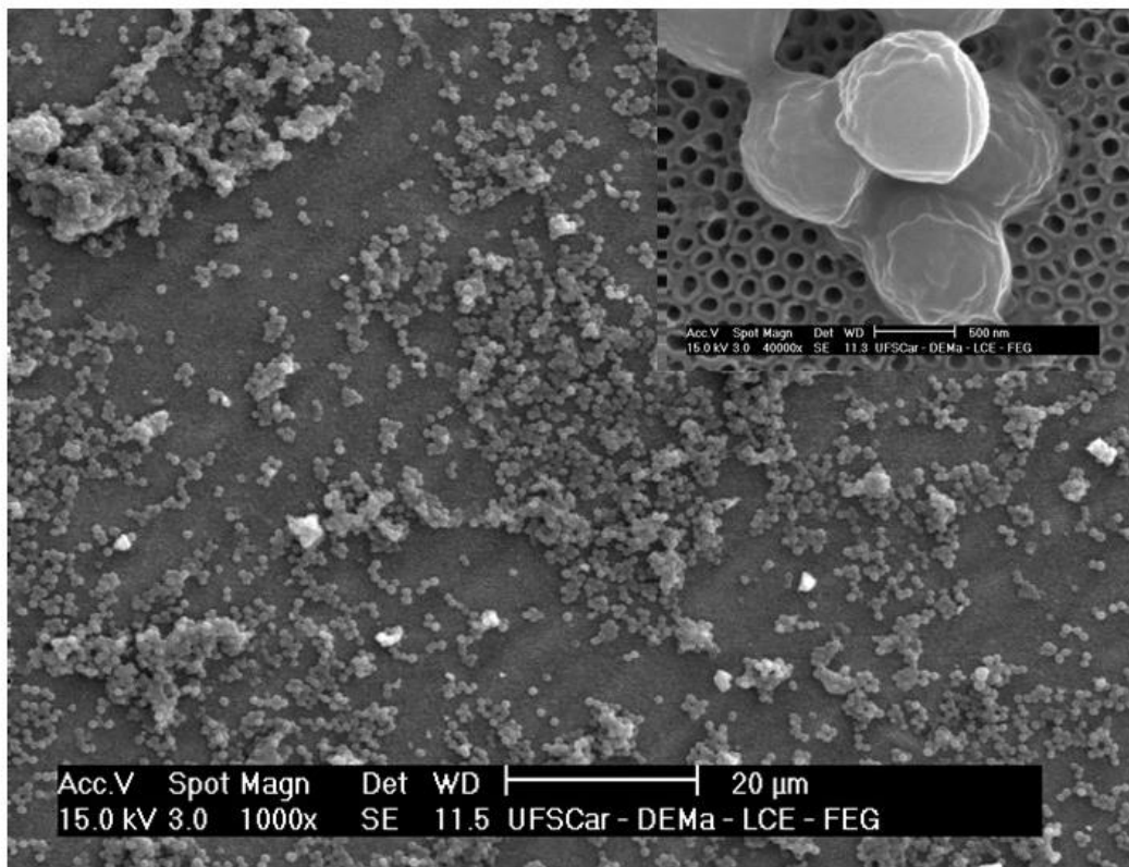
Figura 45 - Superfície da amostra com superfície de nanotubos e recobertos com o biopolímero e partículas de ZnO (solução de 5 mM), com microrganismos crescendo sobre sua superfície.
