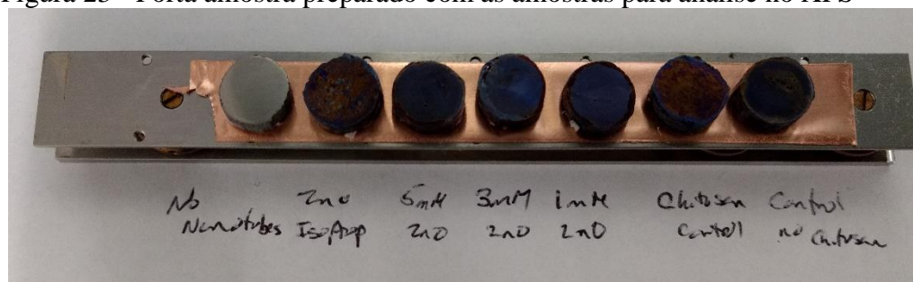
Figura 23 - Porta amostra preparado com as amostras para análise no XPS
