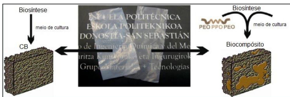
Figura 6. Produção de CB através do cultivo de microrganismos em meio de cultura formando uma matriz polimérica (esquerda). Produção de nanocompósito através da modificação do meio de cultura (modificação “ in situ ”, através da adição de copolímero de block) formando nanocompósito (direita).
