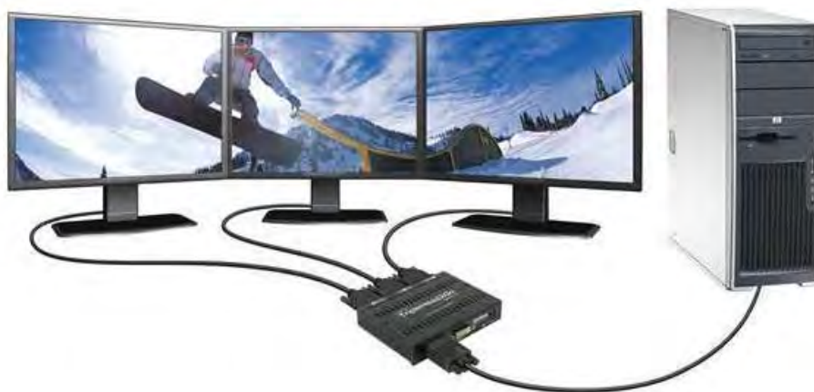
Figura 107 - Imagem ilustrativa com modo de funcionamento da placa de distribuição de sinal Triple Head2Go.
