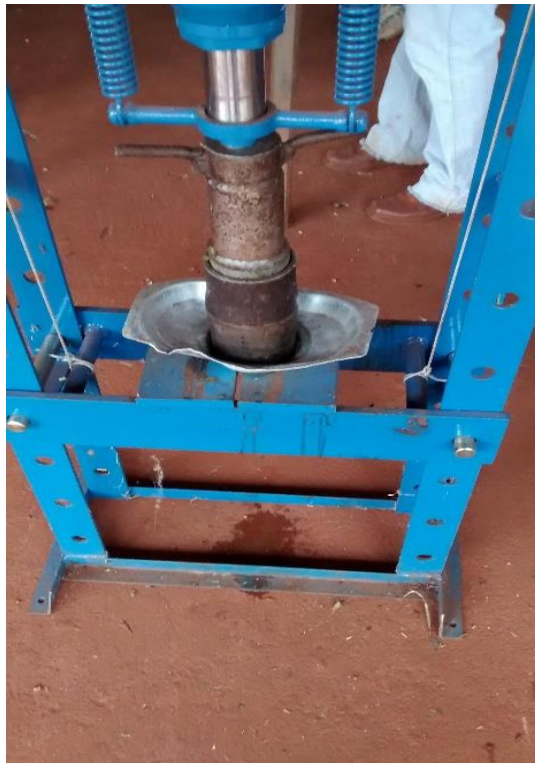
Figura 7- Conjunto de prensa utilizado para extrair o suco da silagem. FEPE. Selvíria, MS.
