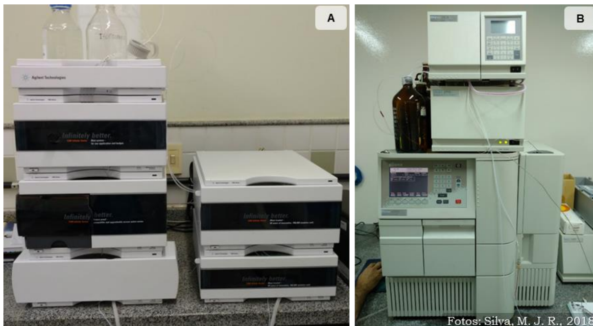
Figura 1 – Cromatógrafos Líquido de Alta Eficiência. A: HPLC Waters, Alliance e2695, equipado com DAD, na Embrapa Semiárido, em Petrolina-PE. B: HPLC Agilent, 1260 Infinity, equipado com DAD, G1315D e RID, G1362A, no Instituto Federal do Sertão Pernambucano, Petrolina-PE.
