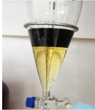
Figura 7. Funil de decantação apresentando a fase aquosa (acima) e fase orgânica (abaixo).
