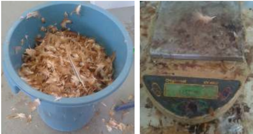
Figura 3.07. - Balde com as penas para a pulverização de resina e balança usada na pesagem das misturas
