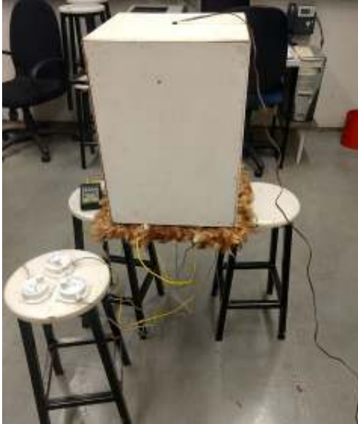
Figura 3.17 . Montagem do sistema de análise térmica dos painéis (bancetas de apoio, Hobos e termômetro digital)
