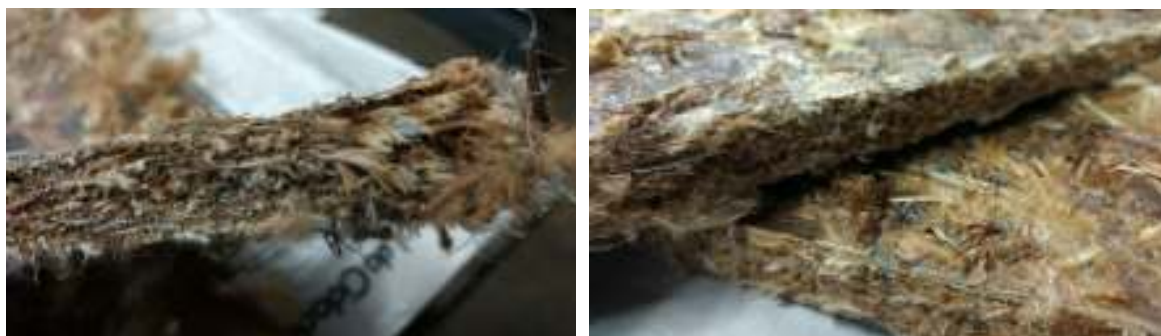
Figura 4.07 - Aparência das linhas de corte de uma das chapas, notando-se a heterogeneidade e fragilidade da seção transversal, com desagregação do material
