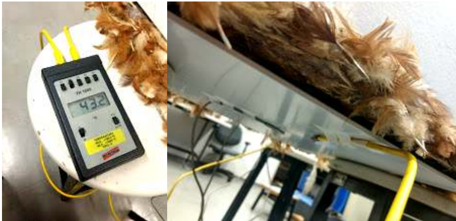
Figura 3.20 - Termômetro digital com os cabos dos sensores e ligação de um dos cabos na face externa do painel de PSAI inferior
