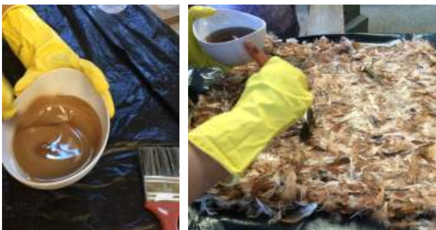
Figura 3.12 - Preparação da resina poliuretana para posterior aplicação nas superfícies da placa
