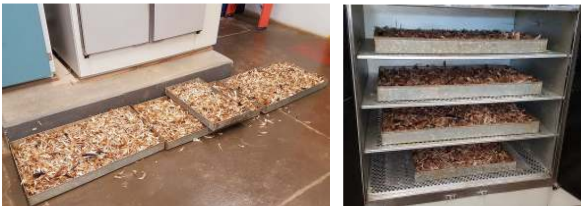
Figura 3.05 - Disposição das penas em bandejas metálicas, para secagem em estufa
