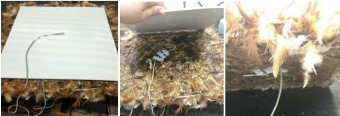
Figura 3.19 - Distribuição dos sensores dos Hobos sobre cada placa
