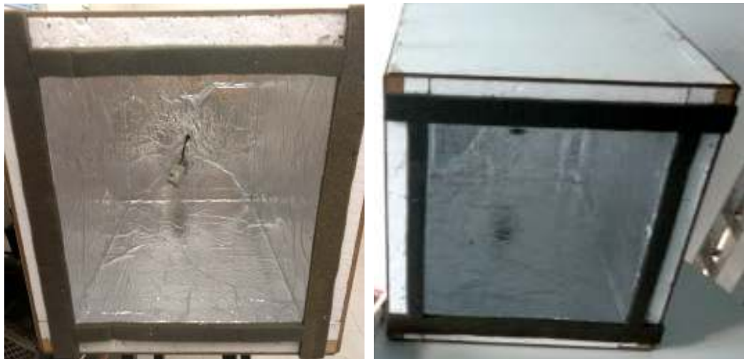
Figura 3.15 . Câmara térmica utilizada nos ensaios de determinação da resistência térmica, cujas dimensões efetivas da abertura são 0,300 m x 0,295 m
