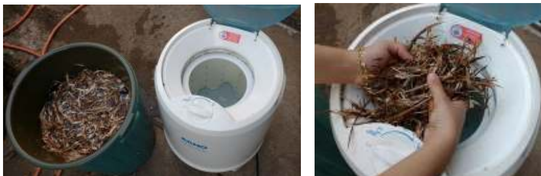
Figura 3.03 - Centrífuga utilizada para retirada do excesso de água das penas, após a lavagem
