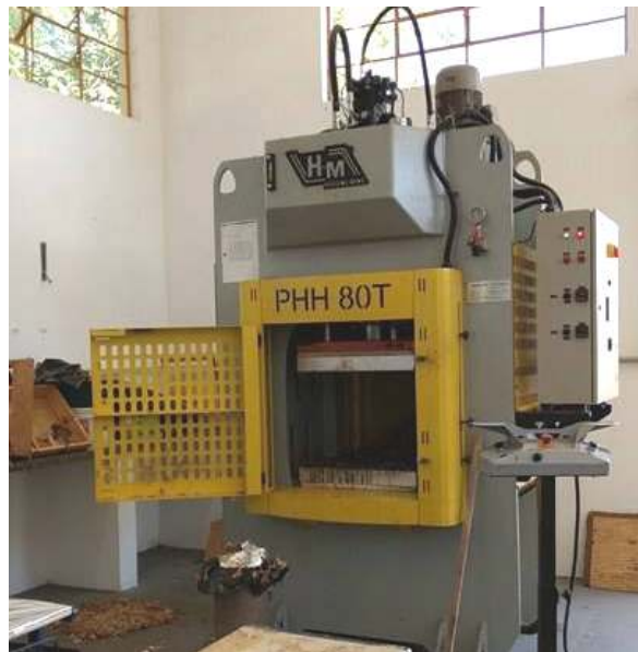
Figura 3.11 - Prensa a quente Hidral Mac PHH 80T
