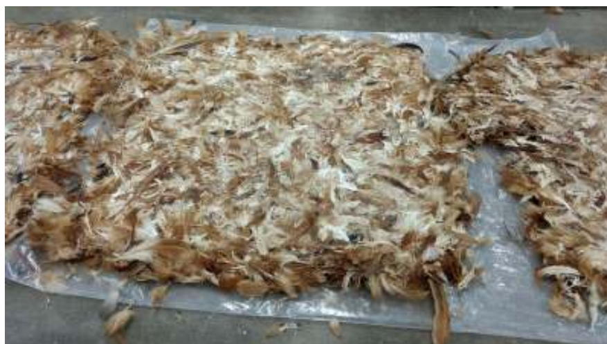
Figura 4.01 - Detalhe da superfície irregular do compósito após a prensagem
