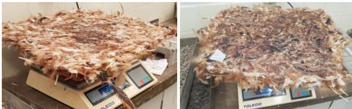
Figura 4.05 - Estado das placas durante a pesagem, antes (à esquerda) e depois (à direita) da pintura com resina
