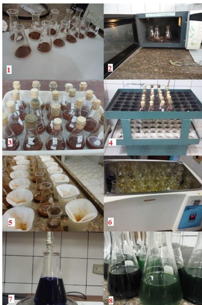
Figura 4.4. Procedimento para quantificação do carbono na biomassa microbiana do solo. (1) Amostras de solo em erlenmeyer; (2) Procedimento de fumigação em forno micro-ondas; (3) Amostras de solo fumigadas e não fumigadas com solução de K_2SO_4 ( 0,5 \text{ mol L}^{-1} ); (4) Agitação para extração; (5) Filtragem da solução com solo; (6) Banho-maria; (7) Titulação; (8) Amostras no ponto final da titulação (ponto de viragem do indicador do roxo para o verde).
