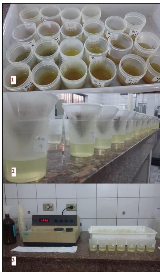
Figura 4.5. Procedimento de análise da hidrólise do diacetato de fluoresceína. (1) Amostras de solo com e sem o substrato FDA; (2) Filtragem de solução com amostra, após a incubação; (3) Leitura em espectrofotômetro.
