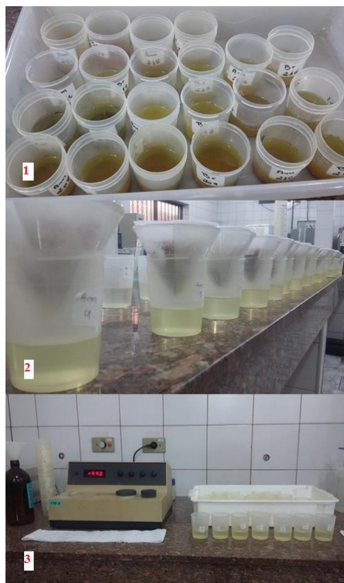
Figura 2.7. Processo de análise de hidrólise do diacetato de fluoresceína. Imagens da autora. (1) Amostras incubadas com e sem substrato; (2) Filtração após o período de incubação; (3) Leitura em espectrofotômetro, no comprimento de onda de 490 nm.
