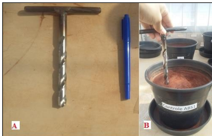
Figura 4.3. Materiais utilizados para coleta de solo. (A) Trado improvisado; (B) procedimento de coleta de solo.
