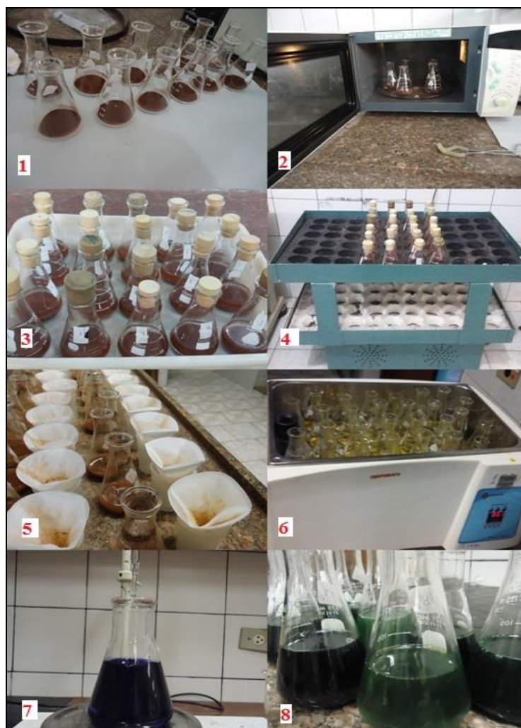
Figura 2.5. (1 – 8). Análise de Biomassa microbiana. Imagens da autora. (1) Amostras pesadas; (2) Amostras irradiadas; (3) Amostras com a solução de K_2SO_4 ( 0,5 \text{ mol L}^{-1} ); (4) Agitação das amostras; (5) Amostras sendo filtradas; (6) solução em banho-maria; (7) Titulação da solução; (8). Solução após ponto de viragem.
