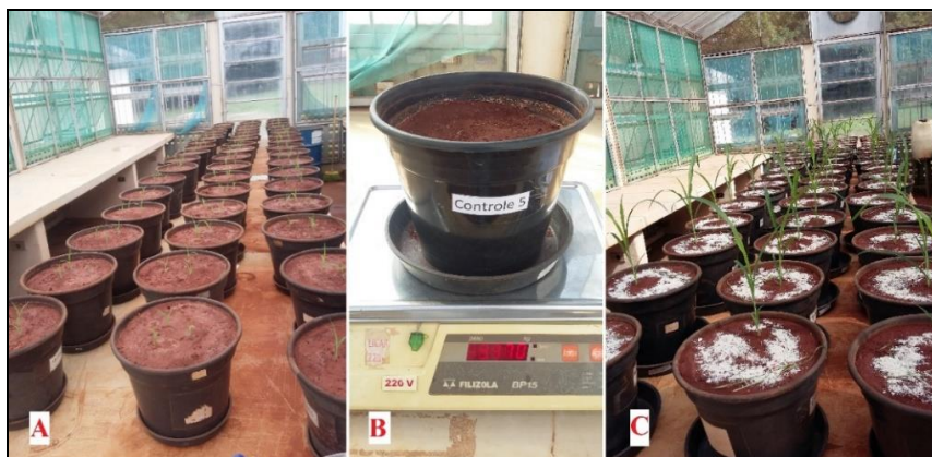
Figura 3.3. Condução do experimento. (A) Plantio de sorgo, com mudas previamente produzidas; (B) Pesagem periódica para manter a umidade; (C) Adubação de cobertura em plantas de sorgo.
