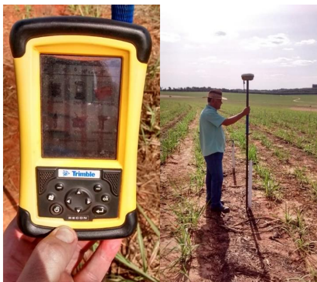
Figura 1. Demarcação e georreferenciamento das parcelas experimentais realizadas com GPS Trimble Recon de alta precisão. (Borebi, 2015).
