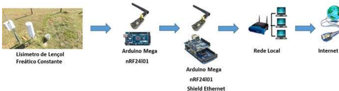
Figura 38 - Estrutura básica de comunicação do hardware.
