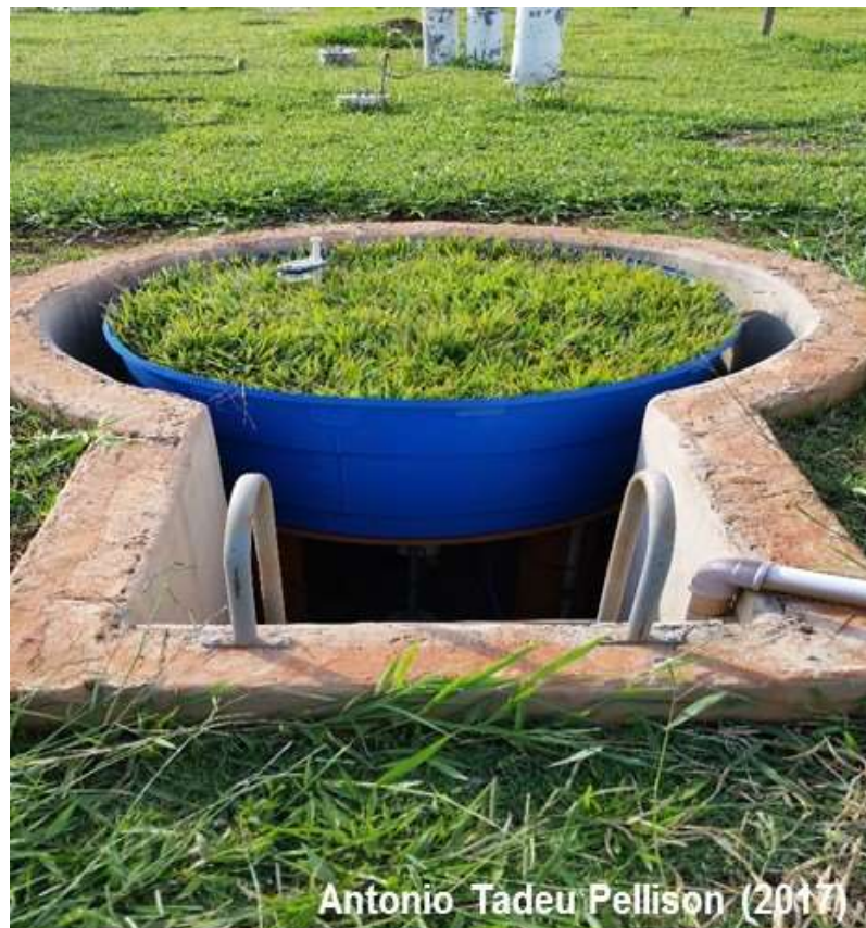
Figura 2 - Lisímetro de pesagem - Departamento de climatologia UNESP- Botucatu
