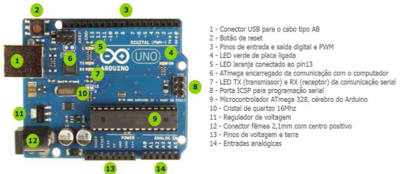
Figura 14 - Componentes de um Arduino.
