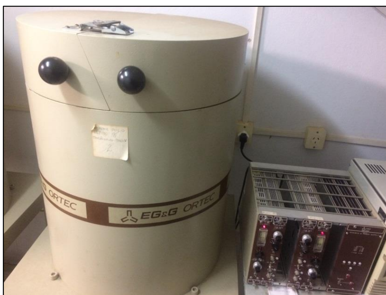
Figura 27 - Espectrômetro gama NaI(Tl), do Laboratório de Isótopos Instáveis (LABIDRO) do DPM/IGCE/UNESP de Rio Claro
