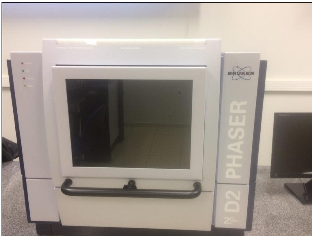
Figura 32 – Difração de raios x do laboratório de radiações ionizantes (LARIN)
