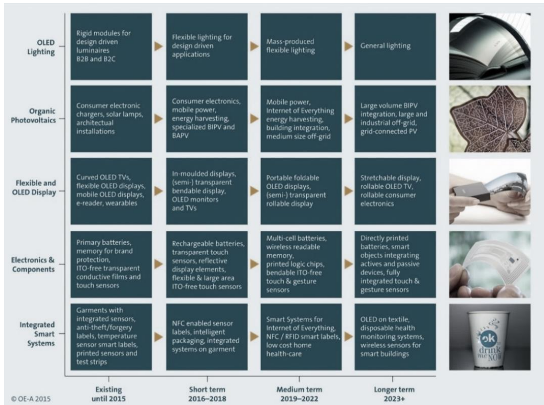
Figura 1.1: Possíveis aplicações futuras de dispositivos impressos, previstos pela Organic Electronic Association (OE-A).
