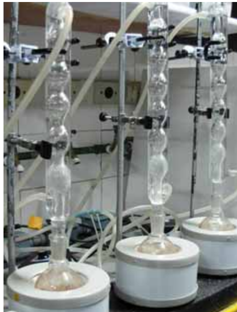
Figura 20. Sistema de refluxo utilizado no presente trabalho.
