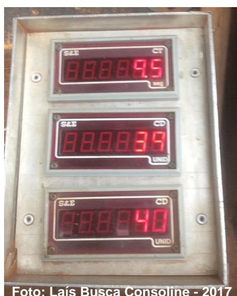
Figura 8 - Painel para aquisição dos dados de tempo e combustível instalado no trator.
