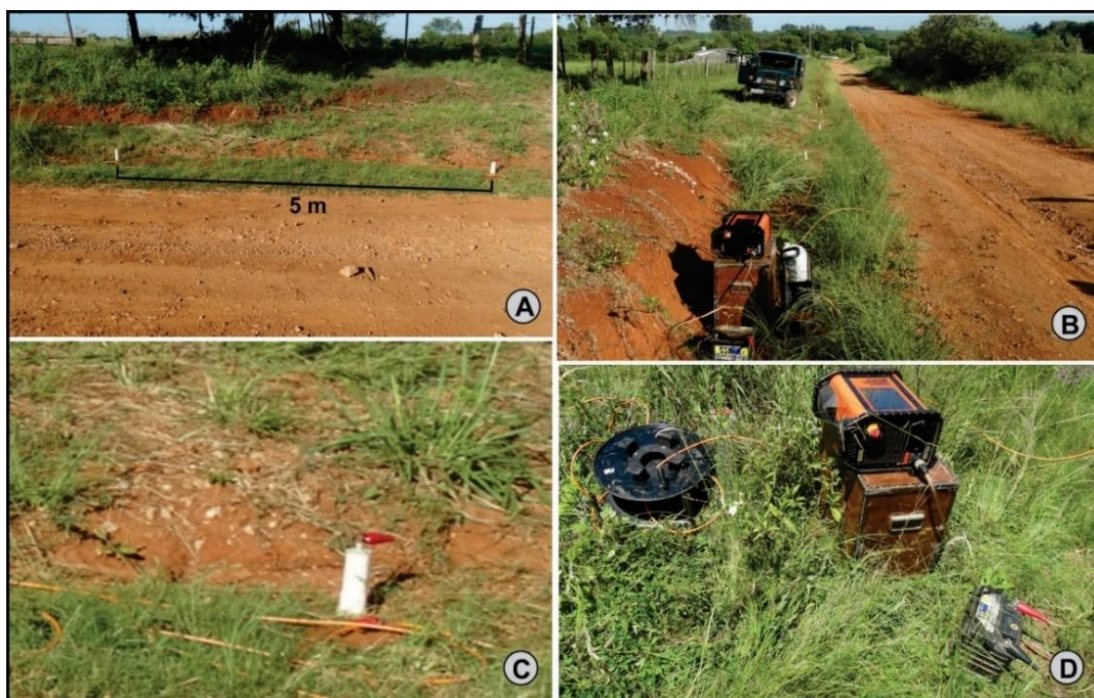
Figura 17: A) Configuração dos eletrodos em campo. B) Eletrodos posicionados para aquisição de dados da L2. C) Eletrodo não-polarizável preenchido por solução de \text{CuSO}_4 . D) Resistivímetro Terrameter LS utilizado na aquisição dos dados.
