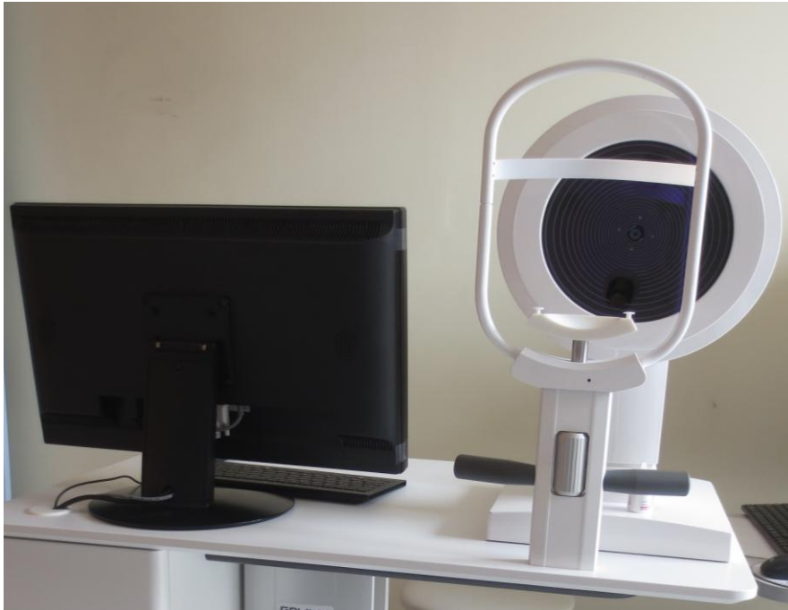
Figura 1 – Aparelho de varredura rotacional Galilei (Ziemer, Suíça) utilizado na pesquisa.
