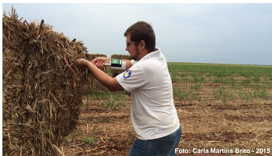
Figura 6 – Medição da umidade nas pilhas a partir do sensor Preagro 25
