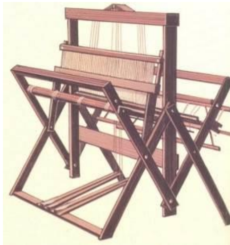
Figura 72: Tear de baixo liço com 4 quadros. Modelo desdobrável.
