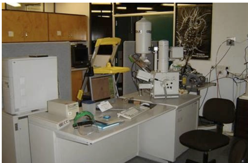
Figura 11. Microscópio eletrônico de varredura com EDS da marca Philips, modelo XL30, instalado no Centro de Microscopia e Microanálises da The University of Queensland (Brisbane, Austrália).
