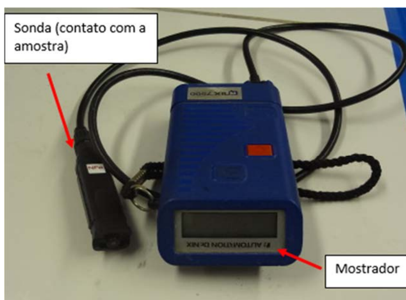
Figura 7: Foto do medidor de espessura de camadas não condutoras por correntes parasitas. Automation Dr. Nix Modelo Qnix 7500.
