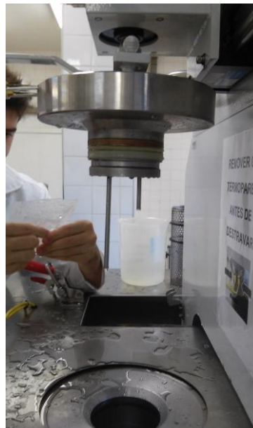
Figura 7 - Detalhe da câmara de alta pressão aberta com as sondas para medição da temperatura do fluido de transmissão de pressão.
