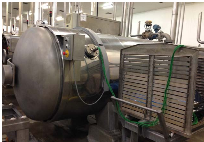
Figura 9: Autoclave e instrumentos para a coleta de dados da penetração e calor
