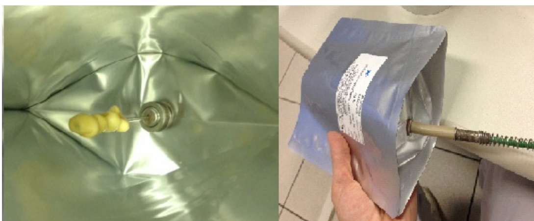
Figura 7: Posição do sensor termopar no centro da embalagem
