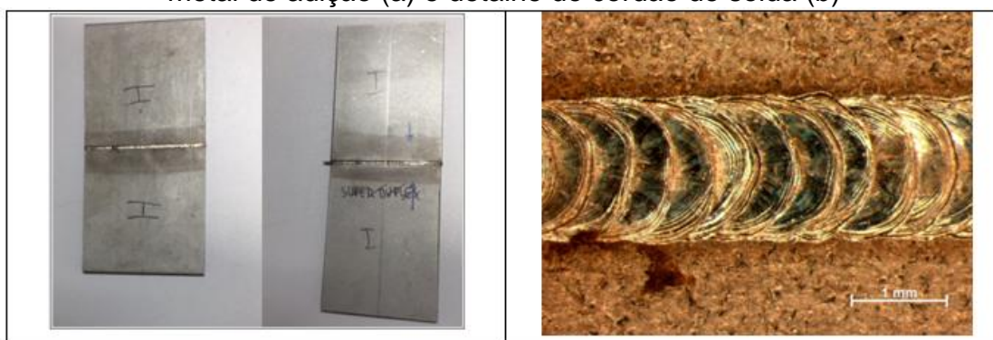
Figura 23 - Vista superior da junta soldada utilizando-se as ligas de níquel como metal de adição (a) e detalhe do cordão de solda (b)
