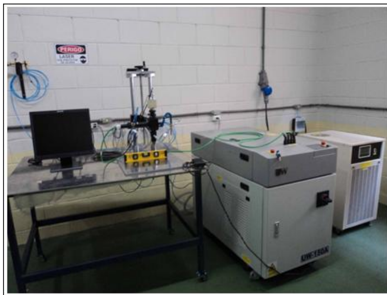
Figura 24 - Equipamento de solda a laser UW 150A pertencente à FEIS/UNESP
