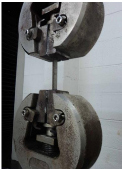
Figura 39 - Corpo de prova preso à pinça da máquina de ensaios de tração
