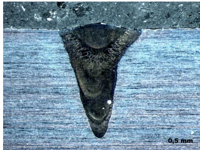
Figura 16 - Macrografia de um exemplo de soldagem a laser
