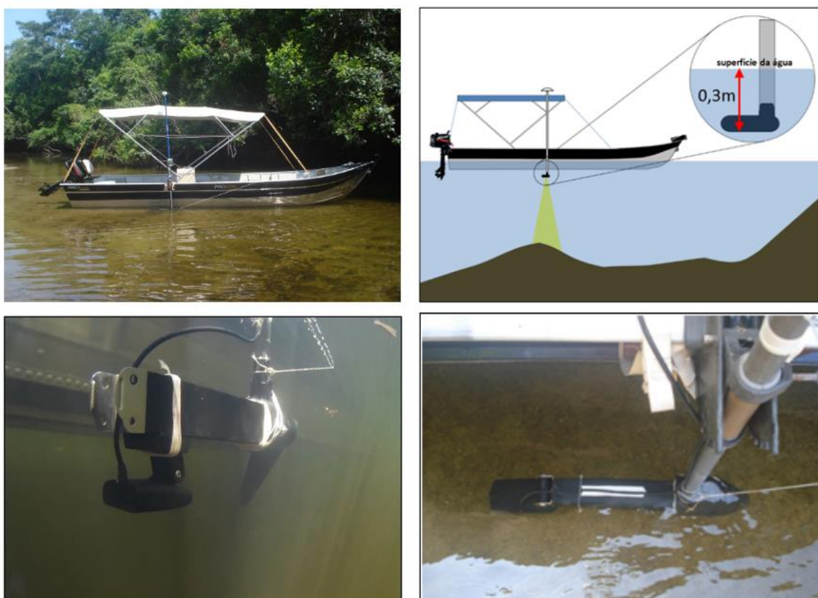
Figura 4.5-1 - Configuração do transdutor e antena do receptor GPS.
