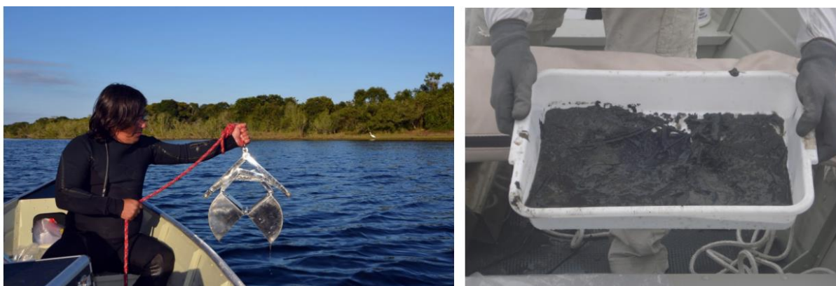
Figura 4.7-1 - Coleta de sedimentos. a) Amostrador/draga Van Veen; b) Sedimento coletado com grande quantidade de lama.
