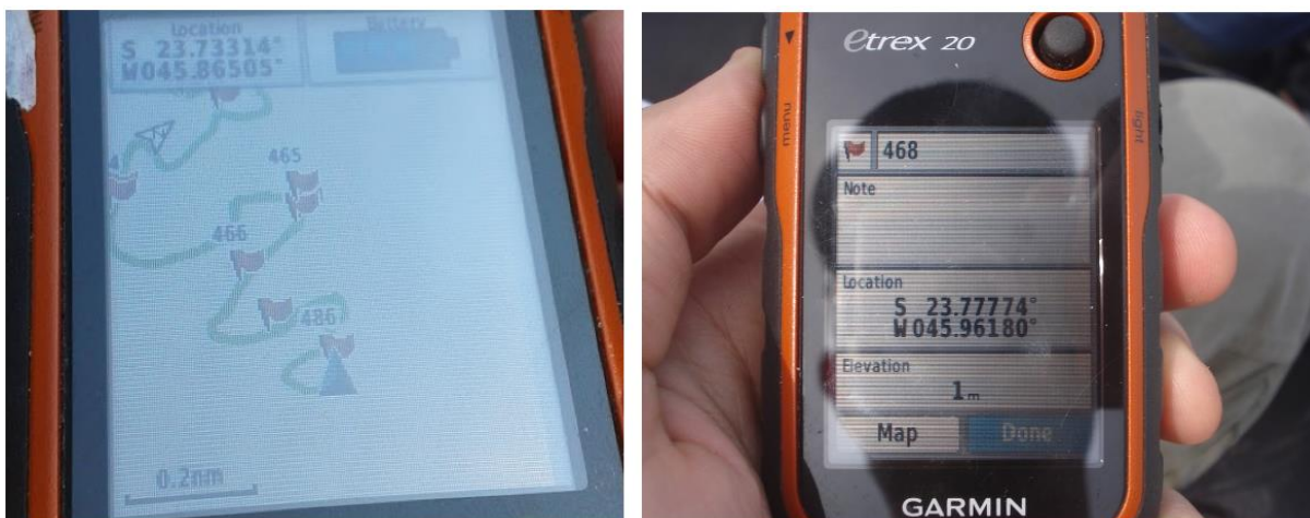
Figura 4.6-3 - GPS Garmin etrex 20, registro dos trajetos e pontos de coleta
