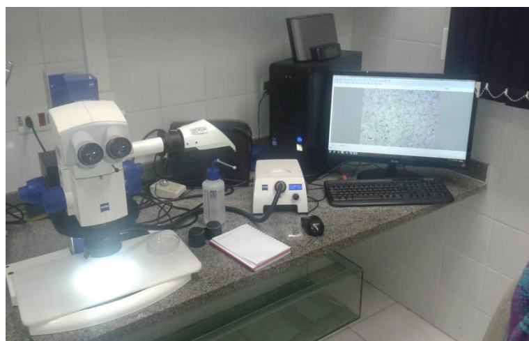
Figura 4.7-2 - Equipamento utilizado para fotografar as amostras de sedimentos
