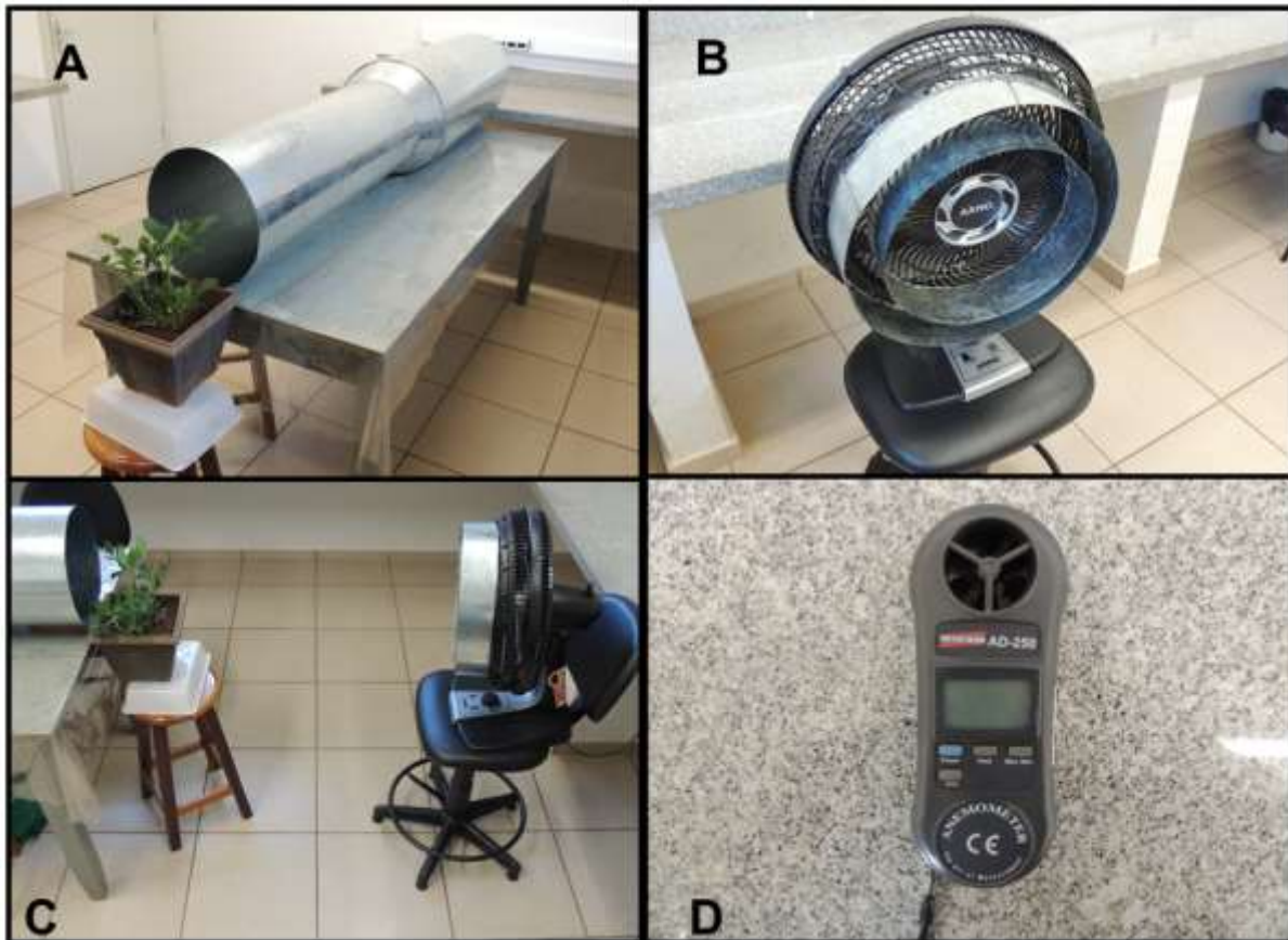
Figura 2. A) túnel de vento; B) discos de zinco posicionados à frente do ventilador; C) planta posicionada na entrada do túnel de vento e ventilador durante o experimento; D) anemômetro utilizado para ajustar a velocidade do vento.
