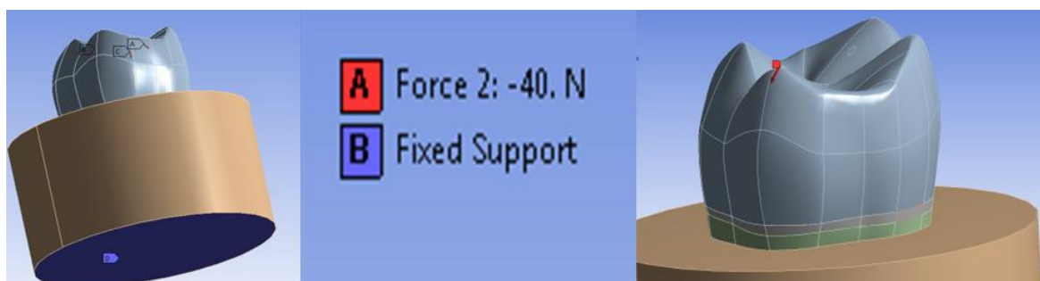
Figura 17 - Fixação em poliuretano e carregamento em um ponto de contato
